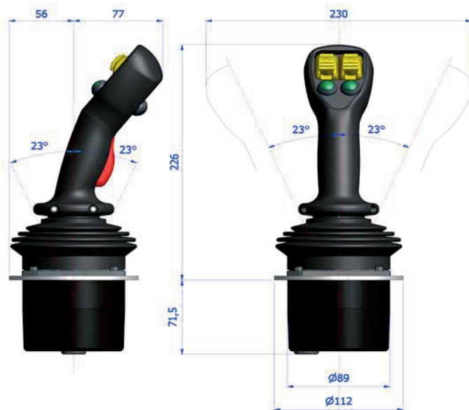
JHD 本体, MS 手柄 完整订购编码: JHD L4C/TT MS A2P9 2FPR R1P9
