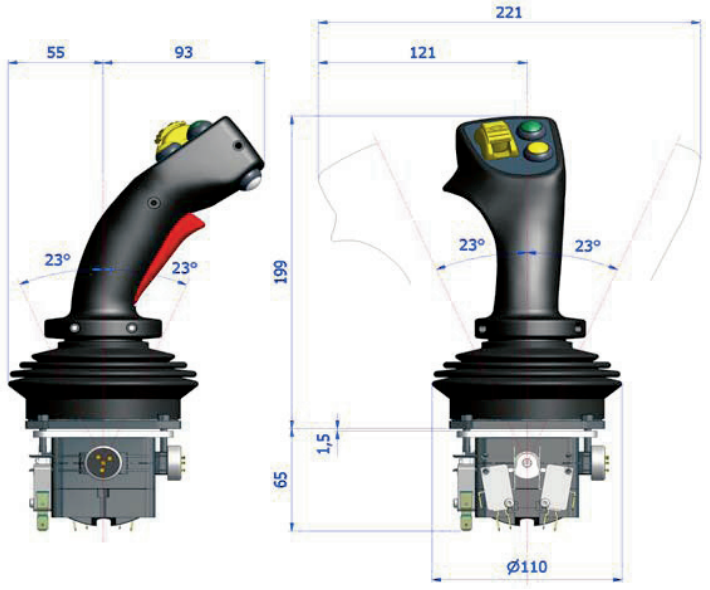
JMF 本体，MG 手柄 完整订购编码：JMF-L4C/NN-MG A2P9 1FPR R1P9
