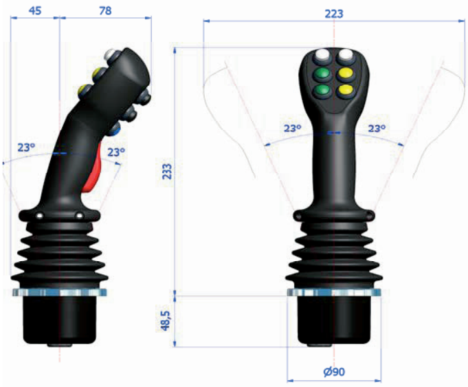
JHM 本体 MS 手柄 完整订购编码：JHM L4D/ANH-MS A6P9 R3P9
